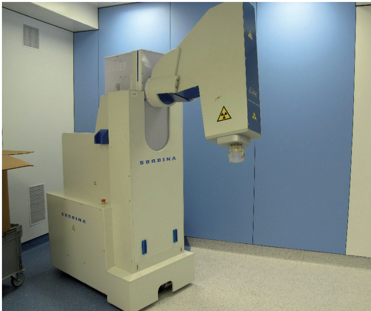
Accelerador lineal mòbil per a irradiació intraoperatòria instal·lat en el radioquiròfan de l'Hospital Clínic de Barcelona.
